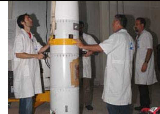
Técnicos argentinos con el módulo de la Carga Útil y la cofia del cohete VS-30 Ensamblado del motor y el cono de acoplamiento
