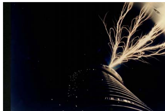
Chispa dentro del tanque. Acelerador TANDAR del CAC-CNEA. Foto: CNEA.
